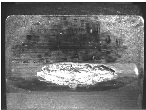
Bild 1: Grübchenschaden beim Kurzzeit-Pittingtest mit FVA2+4%A99
